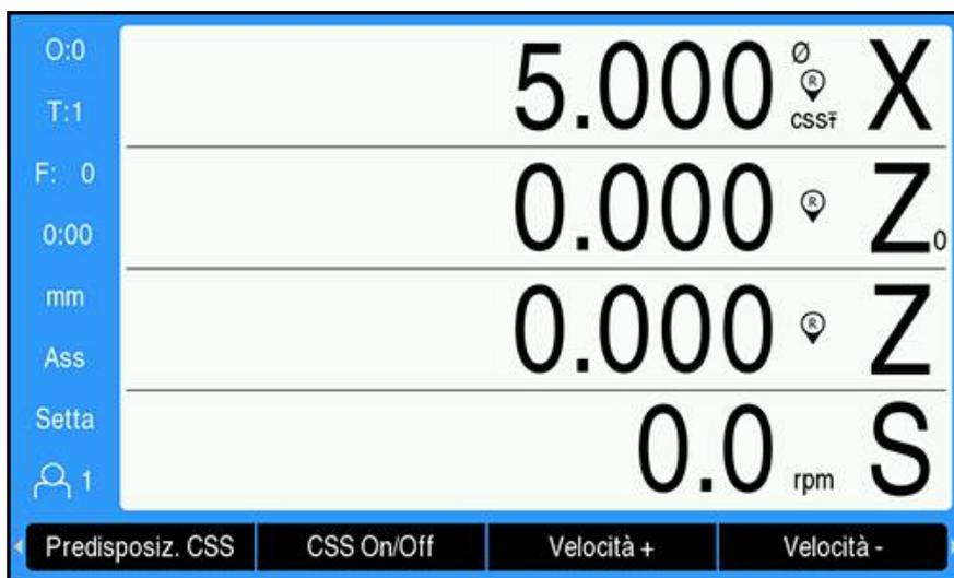
Una volta selezionato il **Modo** operativo e immessi i suoi parametri nel menu **CSS/Diretto giri/min**, per avviare il controllo del mandrino occorre abilitare l'output DAC.
