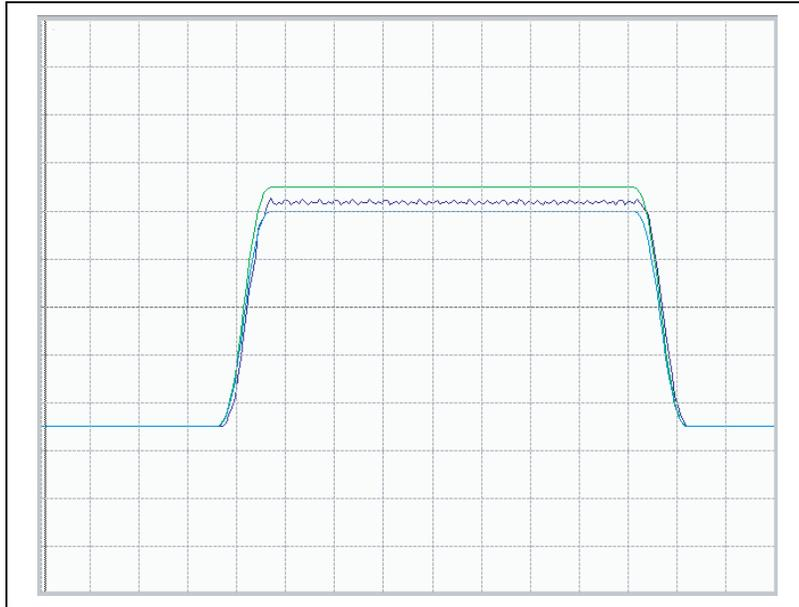
**$V_{nom} \neq V_{act}$ , Speed Adjusted Incorrectly**
