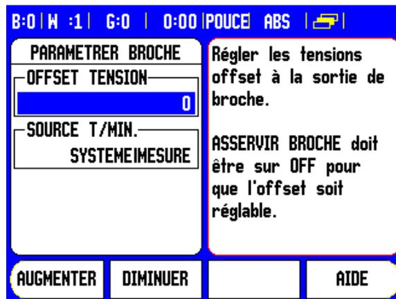
Avec CREATION T/MIN, vous pouvez indiquer si la vitesse de rotation est réellement mesurée par un capteur rotatif, ou calculée par un logiciel qui remplace le capteur rotatif.
