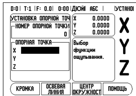
рис. I.12 Устанавливание опорных точек
