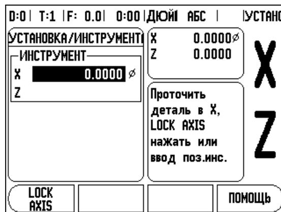
рис. I.24 Маска ввода ИНСТРУМЕНТ/УСТАНОВКА
