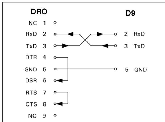
рис. II.16 Занятость пинов последовательного соединения без подтверждения
