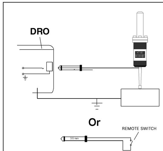
рис. II.13 На массу переключающий кромочный щуп/дистанционный переключатель
