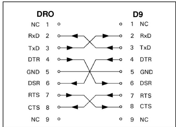
рис. II.15 Занятость пинов последовательного соединения с подтверждением
