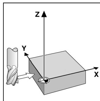
рис. I.11 Устанавливание грани в качестве опорной линии
