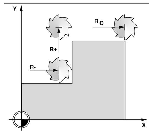
рис. I.13 Коррекция на радиус инструмента
