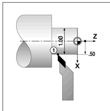
рис. I.28 Деталь к примеру "индикация диаметра и радиуса"
