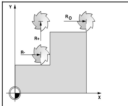
рис. 1.7 Коррекция на радиус инструмента
