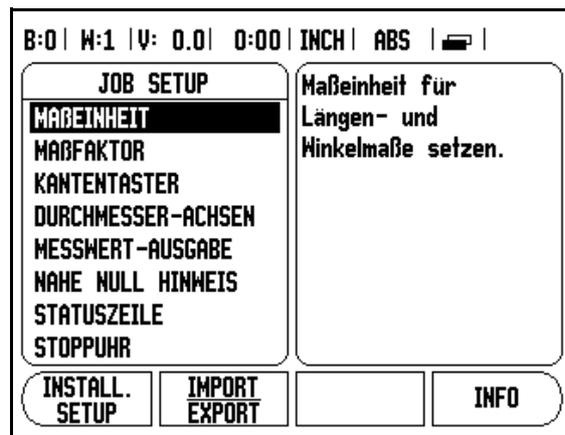
Abb. I.3 Das Menü JOB SETUP beim Fräsen
