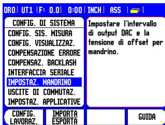
In modalità di configurazione, la barra di stato visualizza la velocità attuale del mandrino in RPM nel campo **S**:
