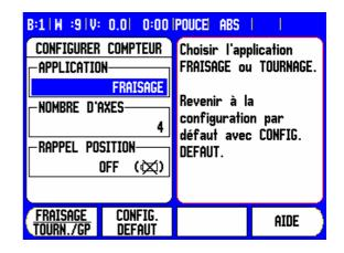
Si la fonction RAPPEL POSITION est active (ON), la visualisation de cotes enregistre la dernière position de chaque axe avant sa mise hors tension et affiche cette position lorsque l'appareil est remis sous tension.
